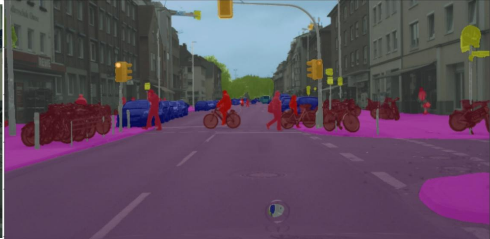
人工知能による読み取り結果 (DeepLabv3+を使用)
